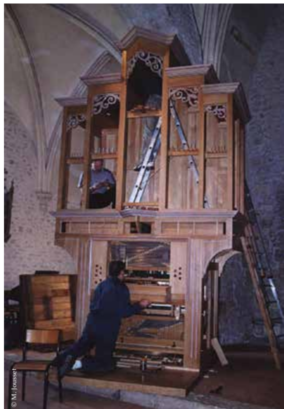
De style XVII e siècle français, il se compose de : douze jeux, deux claviers manuels de cinquante-quatre notes et d'un pédalier de trente notes.
